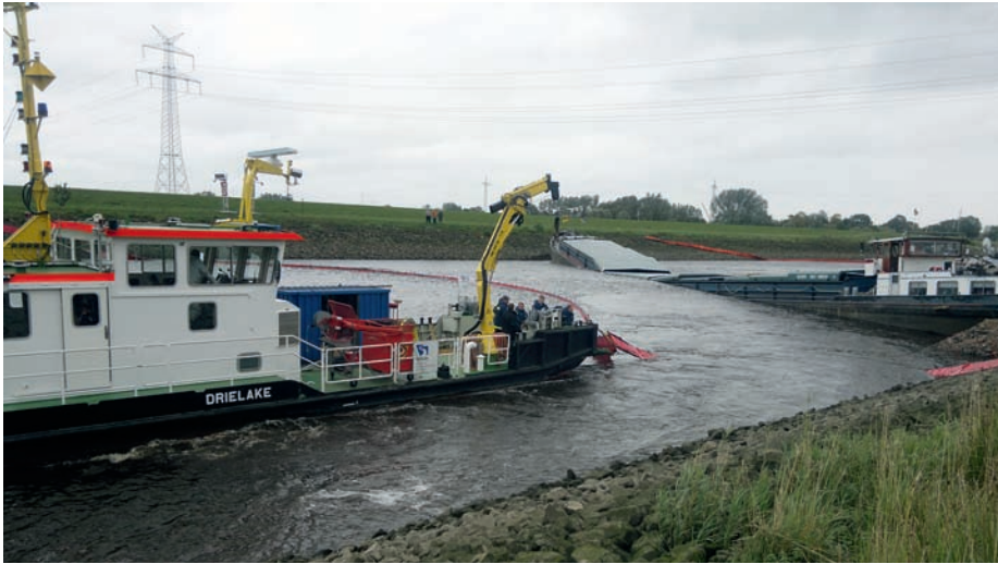
Abb. 3: Das Arbeitsschiff DRIELAKE legt am Havaristen die Ölsperren aus
