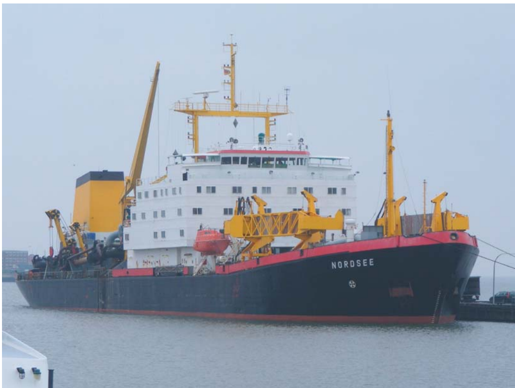
Abb. 1: Laderaumsaugbagger „Nordsee“ Länge über Alles: 131,75 m Tiefgang: 8,75 m
