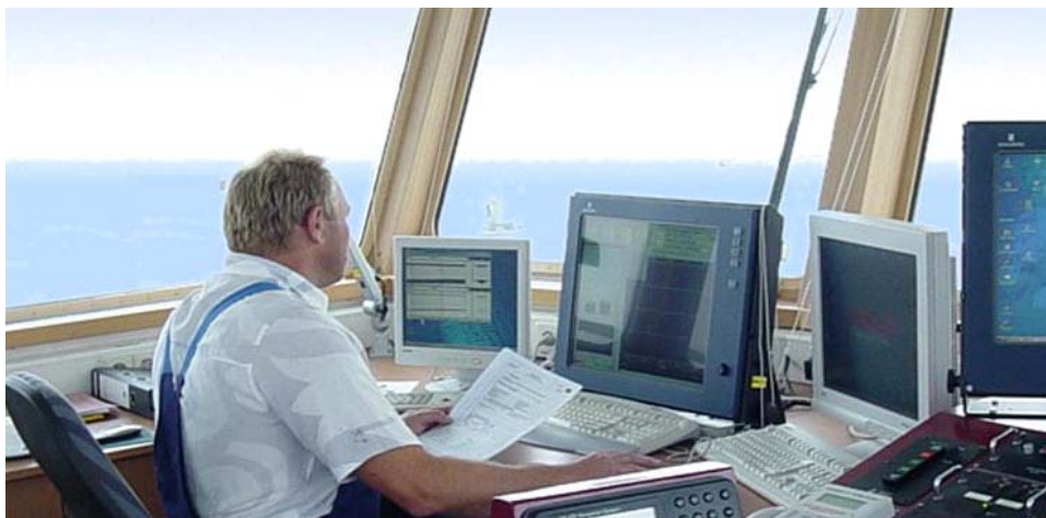
Abb. 2: "Peil"-Arbeitsplatz im Steuerstand eines Vermessungsschiffes
