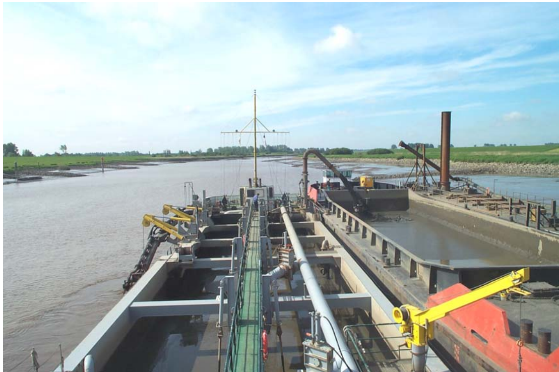
Bild 3: Beladevorgang einer Schute durch einen Hopperbagger
