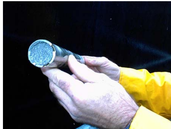
Abb. 3: Stahlkern in der Bohrkron
