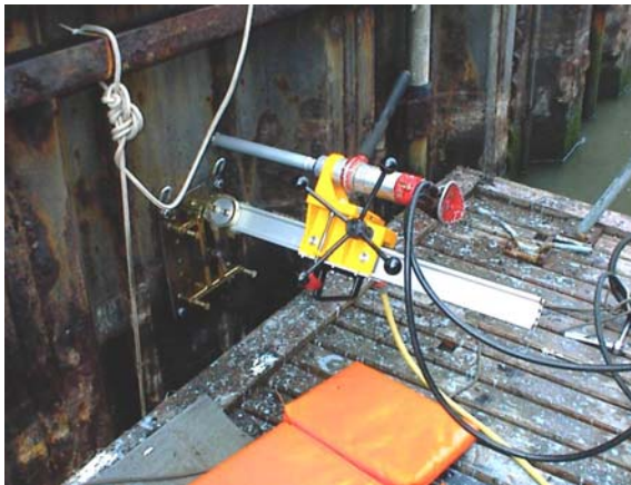
Abb. 2: An der Spundwand montiertes Probeentnahmegert
