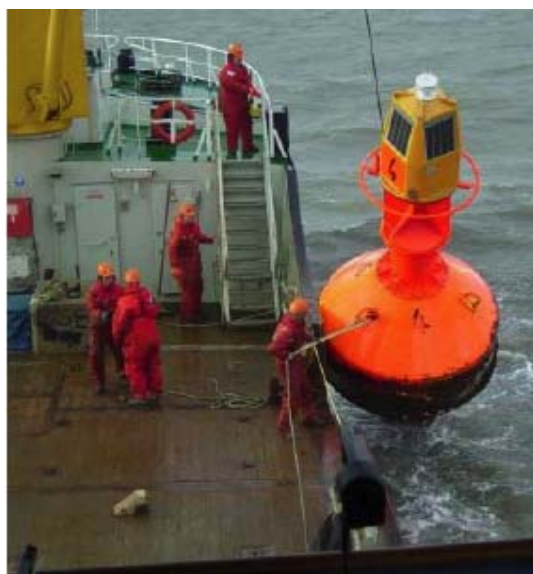
Erprobung einer Leuchttonne mit Kompaktaufsatz und LED-Laterne
