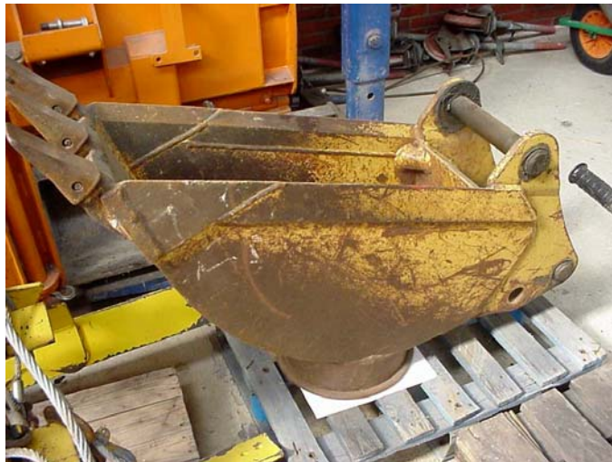
Graben-Tiefen-Löffel des Mehrzweckbaggers
