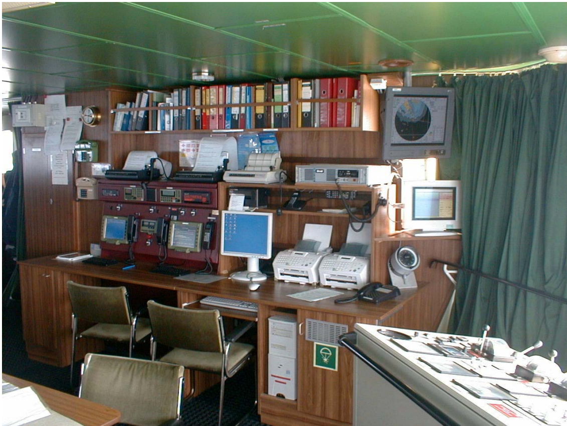
Kommunikationsplatz auf der Brücke des GS "Mellum". Rechts im Bild der Steuerstand der Schleppwinde
