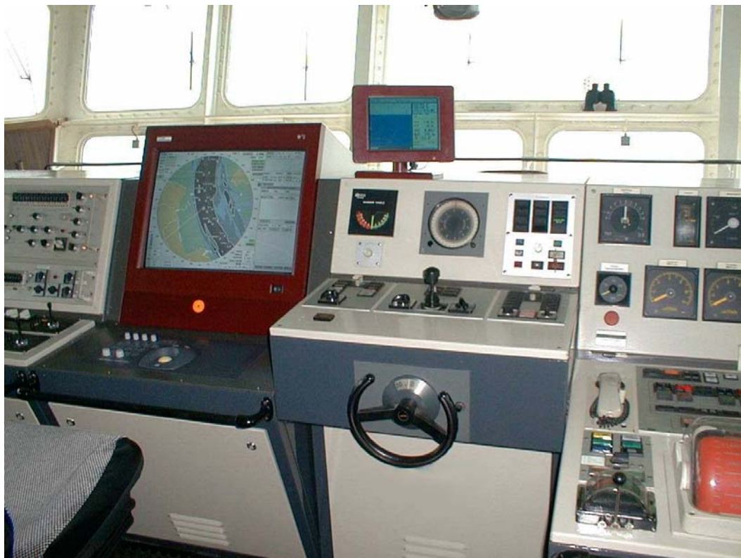
Brücke des GS "Mellum" mit Radar-ECDIS-Sichtgerät
