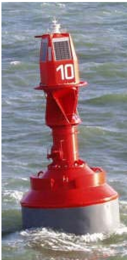
Abb. 3: Fahrwassertonne mit Solarkompaktaufsatz
